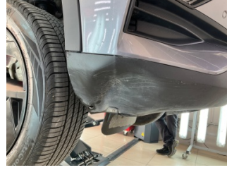
Tampon, ön, Spoiler > Hasarlı
