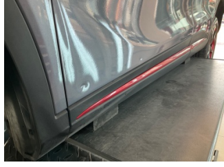
Kapı, sol ön, Kapı, sol ön > Ezik
