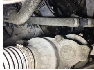
Motor, Motor bloğu > Yağ Kaçağı
