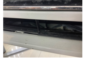
Tampon, ön, Ön tampon ızgarası > Hasarlı
