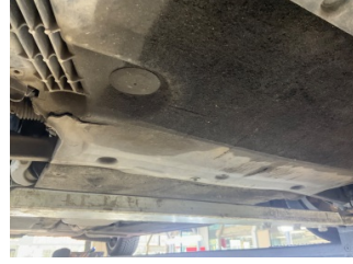
Motor, Alt muhafaza > Hasarlı
