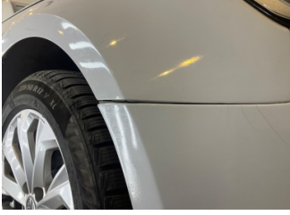
Tampon, ön, Ön tampon > Sabitlemesi Hatalı
