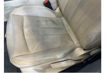
Koltuklar, ön, Koltuk döşemesi, sol ön > Deforme Olmuş
