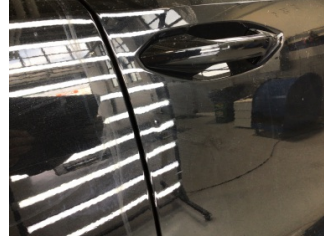
Kapı, sağ ön, Kapı, sağ ön > Küçük Vuruk
